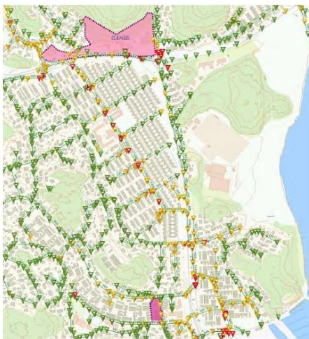
Figur 3. På ledningssträckorna uppstår marköversvämning vid klimatpassat 20-års regn (rödtriangel) och det varnas för vattennivåer över ledningshöjda (gul triangel) [VA-banken, 2021].
